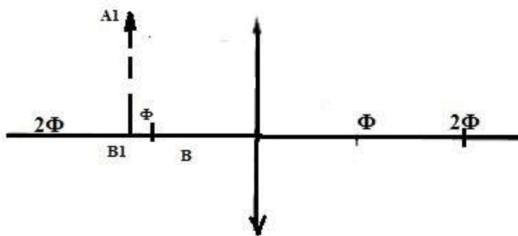
4. Согласно чертежа найти линейное увеличение линзы и оптическую силу линзы
