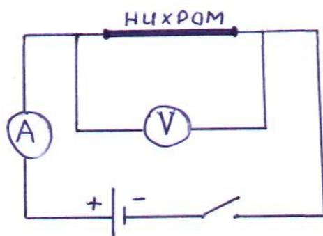
5. Параллельно проволоке подключить вольтметр.
