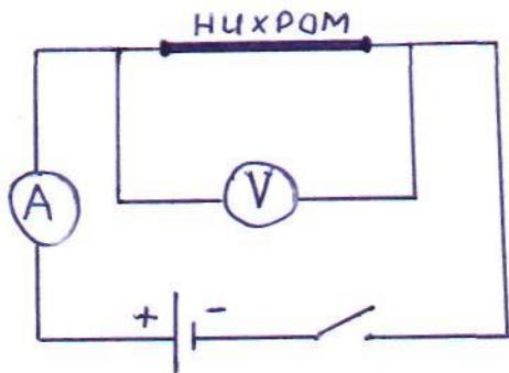
5. Параллельно проволоке подключить вольтметр.
