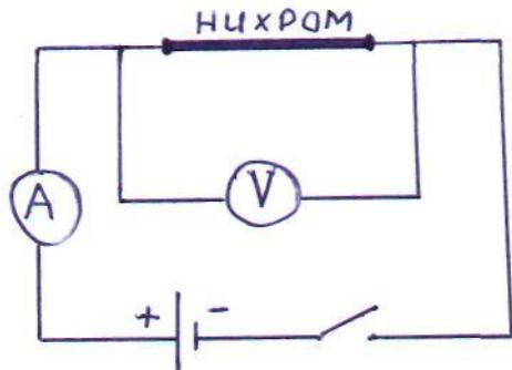
5. Параллельно проволоке подключить вольтметр.
